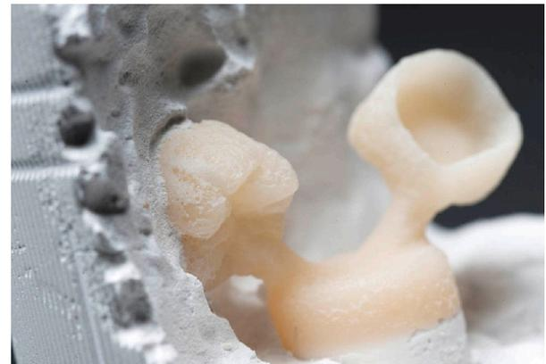
☉4 Das Ergebnis: Pressung mit starker Reaktionsschicht
